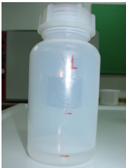
Εικόνα 48: Εισαγωγή του κλωβού με το υπό μέτρηση υλικό στο εσωτερικό φιάλης από πολυαιθυλένιο
