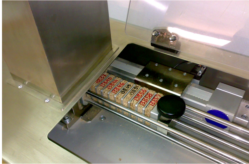
Εικόνα 50: Τοποθέτηση δοκιμίων για προσδιορισμό του προφίλ πυκνότητας
