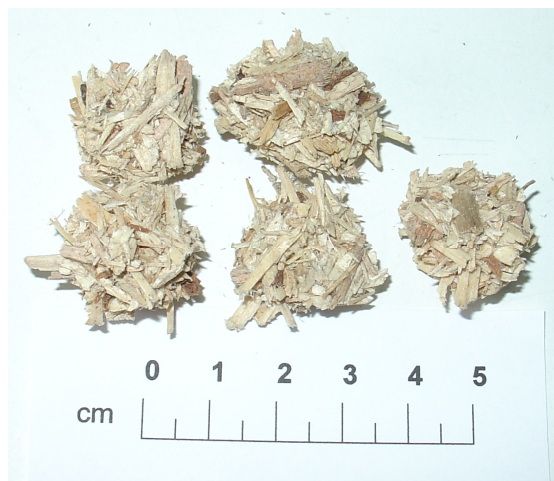
Εικόνα 25: Συσσωματώματα μετά τη διαδικασία του υδροθερμικού χειρισμού
