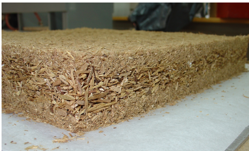
Εικόνα 30: Στρωματωμένο υλικό (mat) πριν το στάδιο της θερμής συμπίεσης
