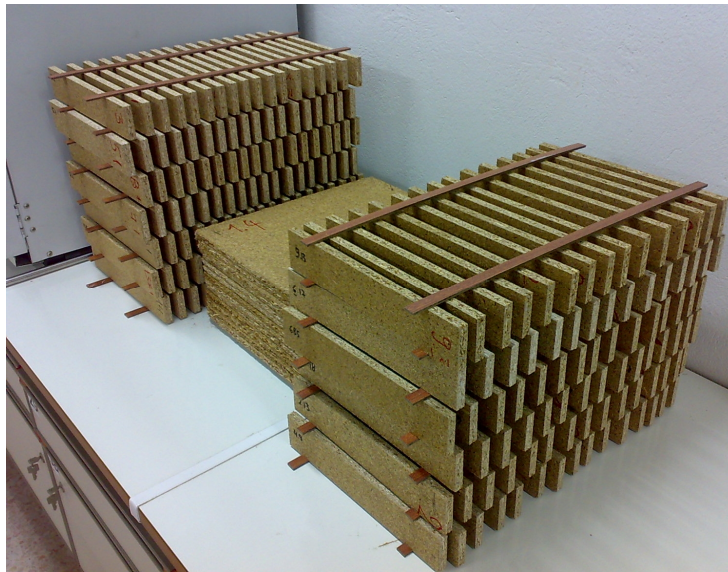
Εικόνα 51: Τα δοκίμια που χρησιμοποιήθηκαν για τον προσδιορισμό του μέτρου θραύσης και μέτρου ελαστικότητας σε κάμψη κατά τη διεξαγωγή της Γ' φάσης της έρευνας
