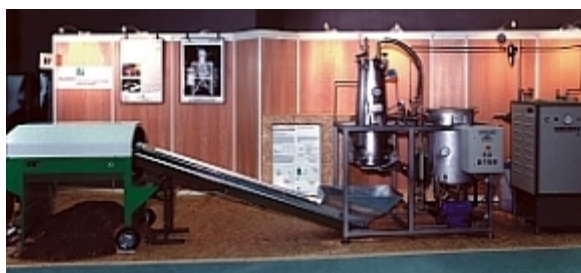
Εικόνα 8: Πιλοτική γραμμή ανάκτησης ξυλοτεμαχιδίων από ξυλοπλάκες με τη μεθοδολογία των Michanickl και Boehme στο Γερμανικό ερευνητικό Ινστιτούτο WKI ( http://www.wki.fraunhofer.de , 2003)
