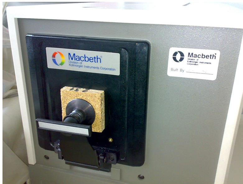
Εικόνα 52: Τοποθέτηση δοκιμίου για προσδιορισμό των χρωματικών μεταβλητών
