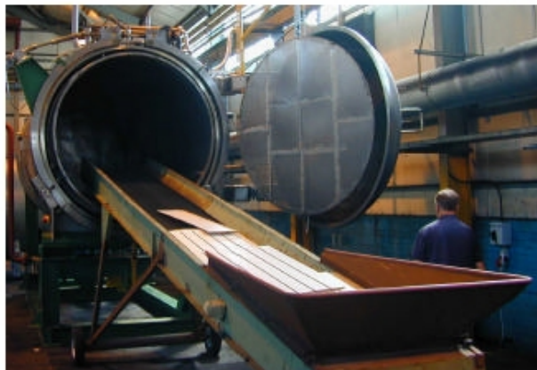
Εικόνα 12: Βιομηχανικός αντιδραστήρας για πιλοτική εφαρμογή της μεθόδου Fibresolve σε βιομηχανία ( http://www.envirofibre.co.uk , 2008)
