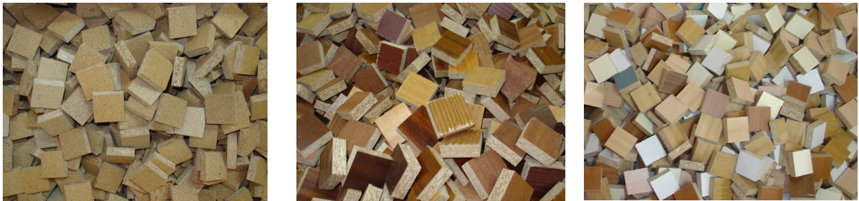
Εικόνα 41: Δείγματα 50x50mm χρησιμοποιημένων μοριοπλακών (αριστερά: γυμνές, κέντρο: επικαλυμμένες με ξυλόφυλλα, δεξιά: επικαλυμμένες με φιλμ μελαμίνης)
