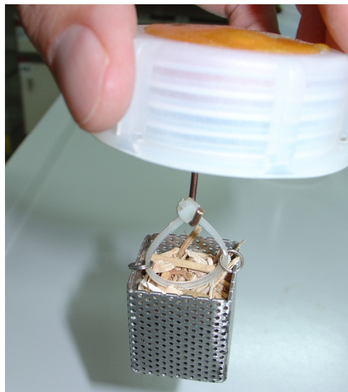
Εικόνα 47: Μεταλλικός κλωβός με το υλικό σταθεροποιημένος στο κάτω μέρος πώματος
