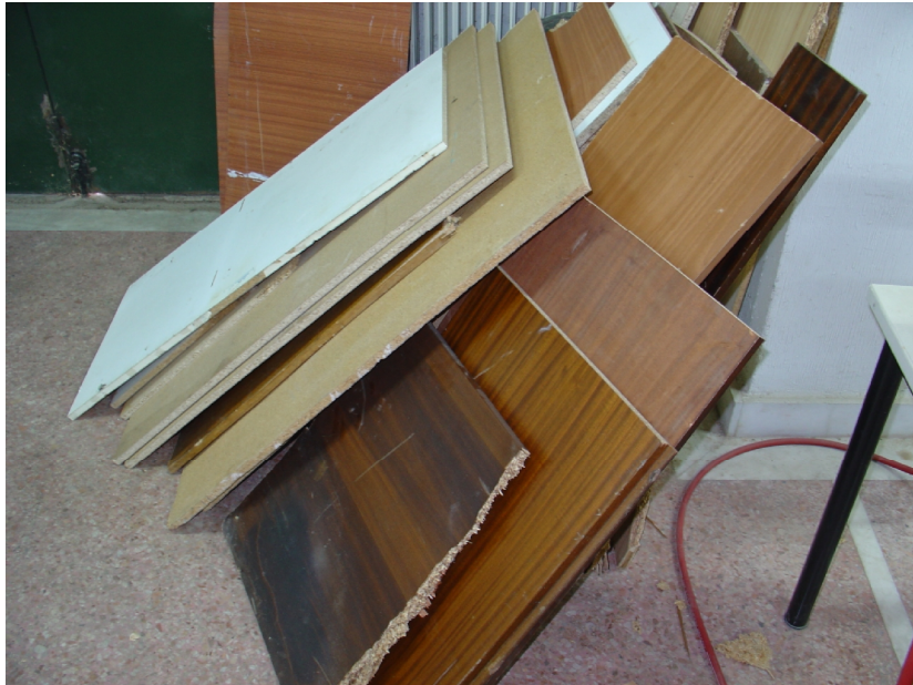
Εικόνα 40: Διαχωρισθείσες ξυλοπλάκες από παλιές ξυλοκατασκευές
