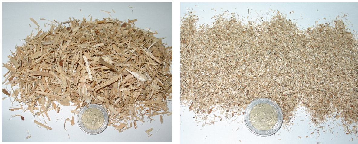
Εικόνα 15: Ξυλοτεμαχίδια βιομηχανίας που χρησιμοποιήθηκαν κατά τη διεξαγωγή της έρευνας (αριστερά: υλικό μεσαίας στρώσης, δεξιά: υλικό επιφανειακών στρώσεων)
