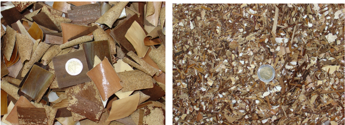
Εικόνα 44: Ανακτημένες επικαλύψεις πριν (αριστερά) και μετά (δεξιά) τον θρυμματισμό τους
